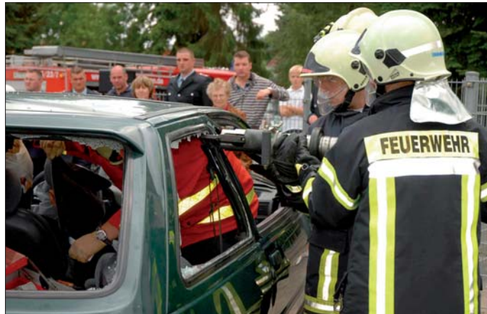
Vorfürungen: Mit der hydraulischen Rettungsschere wurde das Dach eines Ford Fiesta durch die FF Ziethen entfernt. Die Zuschauer schauten gespannt zu.
