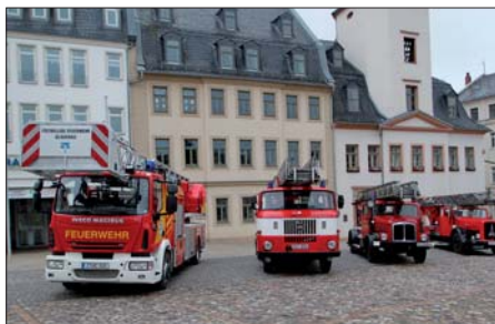
Seltener Anblick: Sieben Jahrzehnte Feuerwehrtechnik, die im Bestand der Wehr waren, gab es auf dem Glauchauer Markt zu bewundern – die DLA (K) 23-12 GL CS von Iveco-Magirus (Bj. 2009), die DL 30 auf W50 L (Bj. 1979), die DL 25 auf S4000-1 (Bj. 1968) und die Magirus-Deutz (Bj. 1938) (v. li.).
